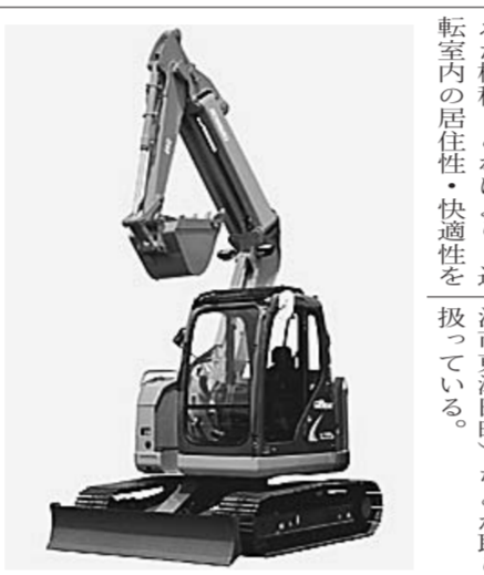
SK75SR Plus コベルコ建設。コベルコ建設(本社・東京都品川区)は、7t級の溝掘りなどの作業が可能...
